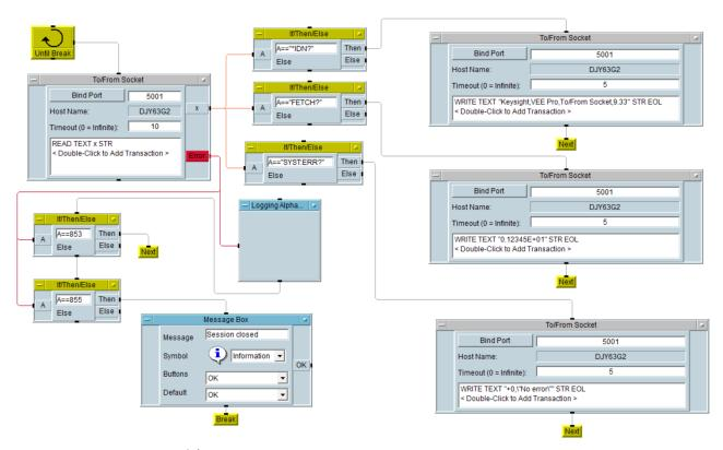
【ソケットのクライアント側プログラム】SocketClient.vee HostNameで指定したIPアドレスに対して、ポート番号5001でソケットの接続を試みます。 ソケット接続後、\*IDN?、FETCH?、SYST:ERR?を1秒ごとに送り、応答を受信します。 最後に、ソケットを切断します。
