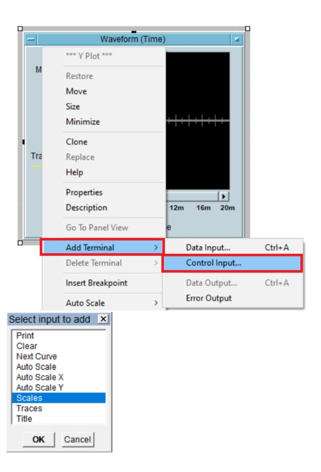
添加Scales的控制输入端后,就可以将坐标的最大值和最小值通过一个Record类型的数据直接输入了。如下图所示,修改Y坐标的最大值和最小值。
