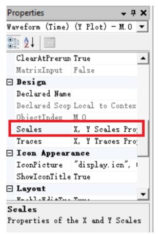
找到Scales属性后,打开该属性编辑框,如下图所示。直接填入最大值和最小值即可。
